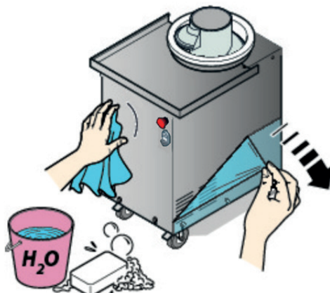
Rimozione pellicola di protezione
