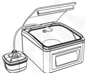
Scarico della tanica per il vuoto
