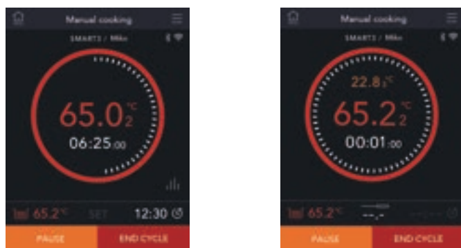
Abb. 6: Garen nach Wassertemperatur (links: über Zeit; rechts: ohne Zeit mit Fühler im Lesemodus)
