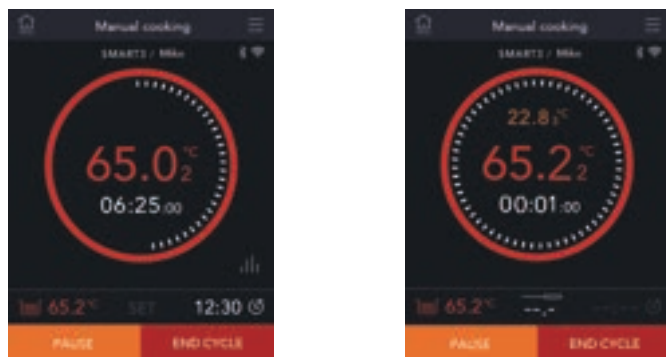
Fig. 6: Cuisson avec la température de l'eau (à gauche : avec durée ; à droite : sans durée et avec sonde en mode lecture)
